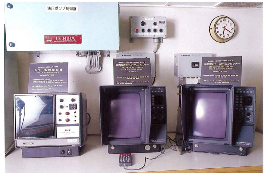
カラスキャンニングソナー(全周型, 半周型) COLOR SCANNING SONARS (360°, 180°)
