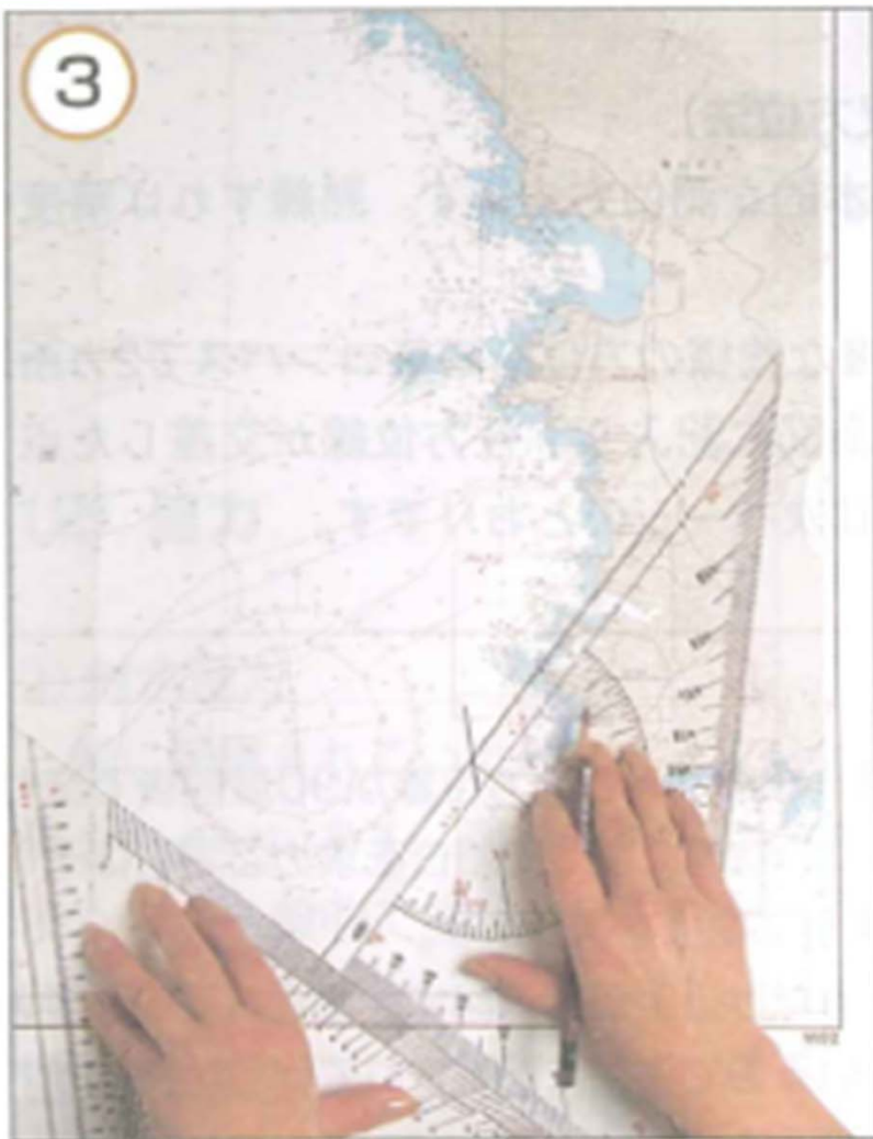
2番目、3番目に測定した物標の方位線を①、②と同様な方法で引く
